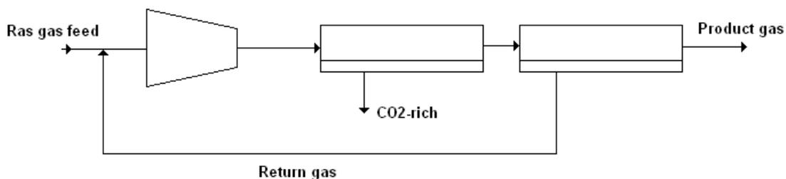
FIGURE 7: COMMON DOUBLE STAGE MEMBRANE CONFIGURATION
